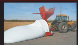
**МАШИНЫ ДЛЯ ЗАГРУЗКИ ЗЕРНА**
