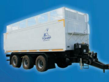
Тракторный прицеп для перевозки силосной массы, навоза и других сельскохозяйственных грузов объемом 47 м<sup>3</sup>. Скорость выгрузки 1,5-2 мин.
