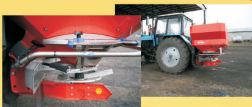
ход штока 10см усилие до 30кг Электрпривод управления дозатором ход штока 40см усилие до 30кг
