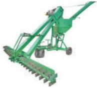
выше бортов кузова, что позволяет без проблем распределять поток зерна от зернометателя по кузову обеспечивая его максимально равномерную загрузку, а пониженная скорость швырания уменьшает повреждение зерна и в частности отбивку зародышей, что является очень важным при погрузке семенного зерна. Большая высота и дальность бросания обеспечивают более полное заполнение складских помещений и отделения легких примесей от зерна при перелопачивании.
