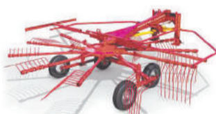
Грабли роторные навесные KOLIBRI 470 ширина захвата до 4,7 м, производительность до 5,6 га/ч,
