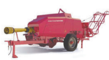
Тюковый пресс-подборщик TUKAN 1600 ширина захвата 1,6 м, производительность до 10 т/ч,
