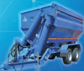
Бункеры-перегрузчики зерна с объемом кузова 22-36 м 3
