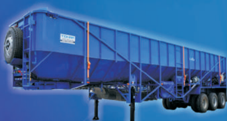
Самосвальный полуприцеп (с донным транспортером) для перевозки картофеля и других сельскохозяйственных культур
