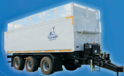
Тракторный прицеп для перевозки силосной массы, навоза и других сельскохозяйственных грузов объемом 47 м 3 . Скорость выгрузки 1,5-2 мин.
