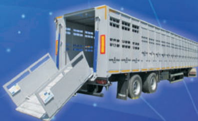
Полуприцепы для перевозки снота (КРС, свиньи, овцы и др.) в один или несколько ярусов
