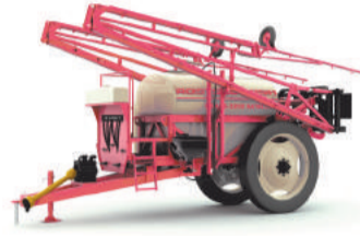
Прицепной опрыскиватель RSM TS 3200 SATELLITE объем бака 3200 л ширина захвата 24 и 27 м норма вылива от 70 до 300 л/мин
