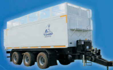
Транкторный прицеп для перевозки силосной массы, навоза и других сельскохозяйственных грузов объемом 47 м 3 . Скорость выгрузки 1,5-2 мин.
