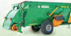
Погрузчик-раздатчик-смеситель кормов ПРСК-12
