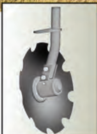
Индивидуальная стойка предотвращает забивание.
