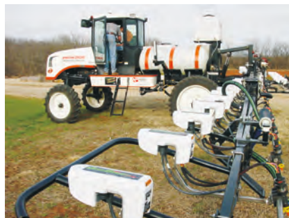
Рис. 5 Подключение системы к каждому распылителю
