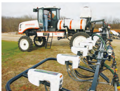
Рис. 5 Подключение системы к каждому распылителю
