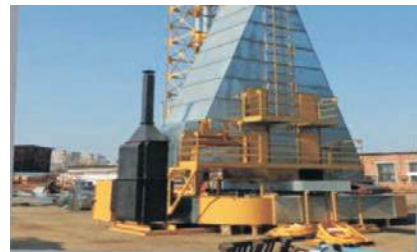
Сушилки зерновые шахтные стационарного типа производительностью 5 плановых тонн в час на твердом топливе (совместное производство с ОАО «Брестсельмаш», г. Брест.)
