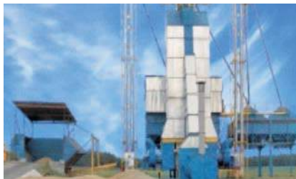
Зерноочистительно-сушильные комплексы производительностью 20 и 30 плановых тонн в час ЗСК-20, ЗСК-30 (совместное производство с ОАО «Брестсельмаш», г. Брест.)
