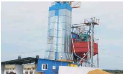
Сушилки зерновые шахтные стационарного типа производительностью 8, 16, 20, 30, 40 плановых тонн в час (совместное производство с ОАО «Брестсельмаш», г. Брест.)
