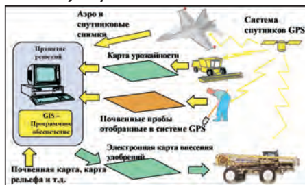
Рис. 2. Основные элементы блоков технологии дифференцированного применения удобрений
