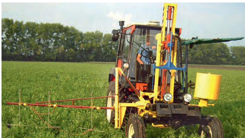
Рисунок 2. Мобильное средство для диагностики параметров плодородия поля
