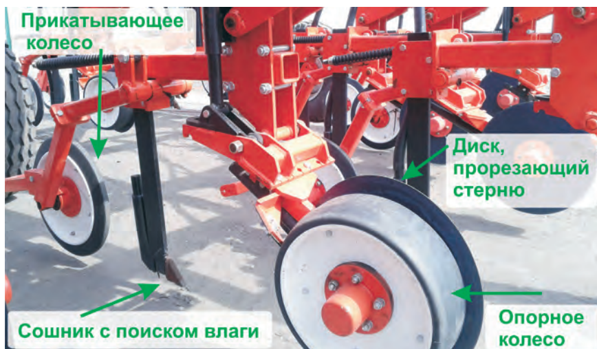
Фото 1 Конструкция австралийской сеялки. Каждый сошник соединен со своим параллелограммом, 100-процентно копирующем рельеф почвы. Расстояние хода параллелограмма 30 см.
