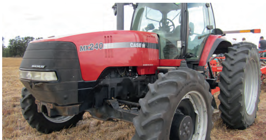
Фото 2 Европейские и американские трактора, поставляемые на экспорт в Австралию, сразу имеют одинаковую ширину колеи для передних и задних колес
