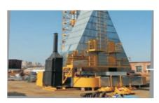
Сушилки зерновые шахтные стационарного типа производительностью 5 плановых тонн в час на твердом топливе (совместное производство с ОАО «Брестсельмаш», г. Брест.)
