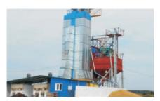
Сушилки зерновые шахтные стационарного типа производительностью 8, 16, 20, 30, 40 плановых тонн в час (совместное производство с ОАО «Брестсельмаш», г. Брест.)
