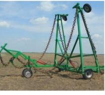
вых по нулевой технологии (NO-TILL) применяется для закрытия влаги, летней обработки паровых полей. Борона предназначена для разрушения почвенной корки, рыхления и выравнивания верхнего слоя почвы, частичного удаления сорняков и мульчирования почвы, равномерного распределения пожнивших остатков.
