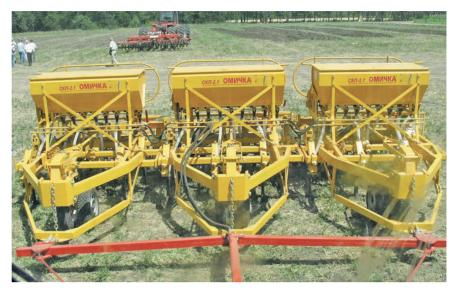
базе сеялки СКП-2,1 с шириной междурядий 300мм и анкерным рабочим органом. Данная сеялка предназначена для нулевой технологи(NO-TiLL) возделывания зерновых
