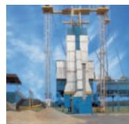
**ЗЕРНООЧИСТИТЕЛЬНО-СУШИЛЬНЫЕ КОМПЛЕКСЫ** производительностью 20 и 30 плановых тонн в час ЗСК-20, ЗСК-30 (совместное производство с ОАО «Брестсельмаш», г. Брест).
