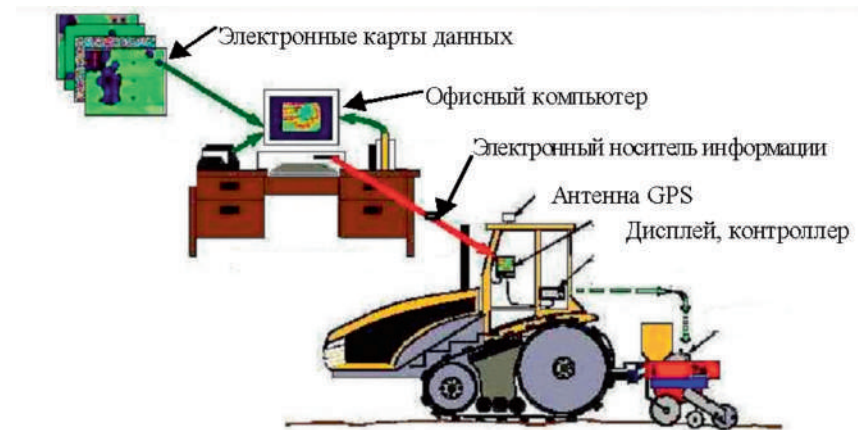
Рис. 1. Дифференцированное внесение удобрений в соответствии с электронной картой
