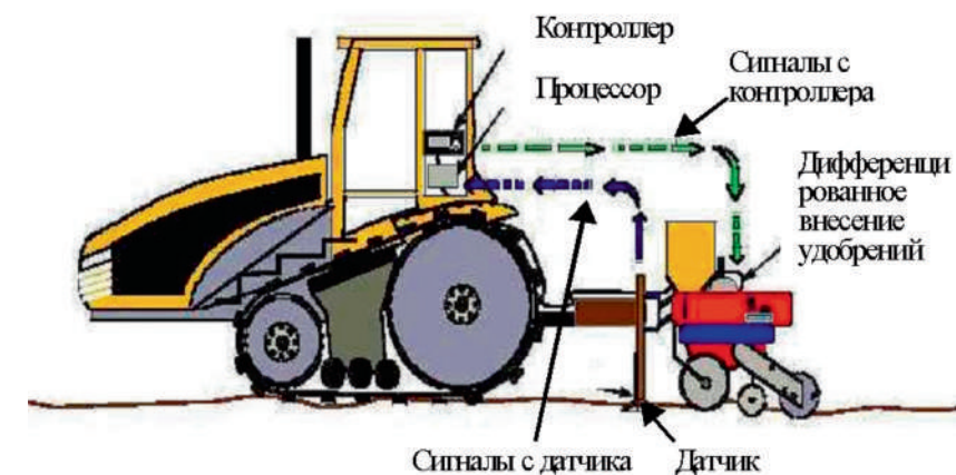
Рис. 2. Дифференцированное внесение удобрений в соответствии с показаниями датчика
