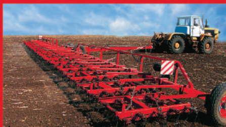
«ЛИРА» Борона зубопружинная широкозахватная гидрофицированная
