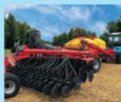
**ЗЛАТНИК** - пневматическая севалка с шириной захвата 6 м, производительность 5 гектаров/час
