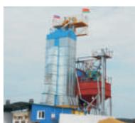
**СУШИЛКИ зерновые шахтные стационарного типа** производительностью 8, 16, 20, 30, 40 плановых тонн в час (совместное производство с ОАО «Брестсельмаш», г. Брест.)
