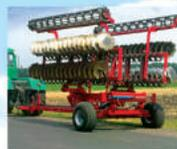
**ТАЛЕР** - системный носитель для образования широкозахватных агрегатов разного типа (8 м)
