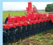
**КРОНА** - приставки прямого сева к серийным зерновым сеялкам типа СЗ (3,6, 5,4)
