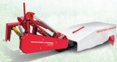
Косилка ротационная навесная STRIGE 2400 ширина захвата 2,4 м производительность 3,6 га/ч
