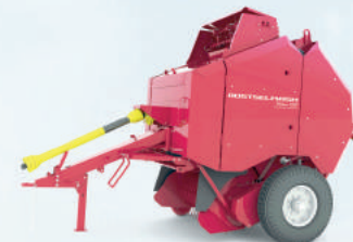
Пресс-подборщик рулонный PELIKAN 1200 ширина захвата 1,45 м производительность до 10 т/ч
