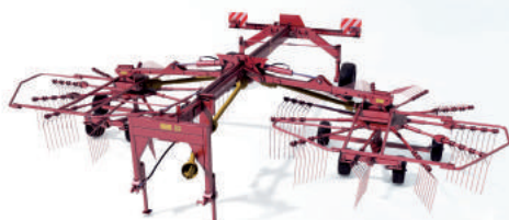
Грабли 2-роторные прицепные KOLIBRI DUO ширина захвата – 6,8–7,6 м производительность 7,7га/ч
