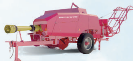
Пресс-подборщик тюковый TUKAN 1600 ширина захвата 1,55 м производительность 10 т/ч
