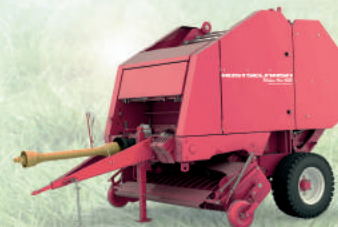
Пресс-подборщик рулонный PELIKAN MAX ширина захвата 2 м производительность до 13 т/ч
