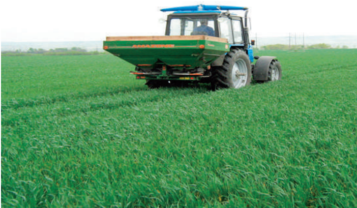
Рис. 6. Дифференцированное внесение азотных удобрений по показаниям N-сенсора, установленного над кабиной трактора
