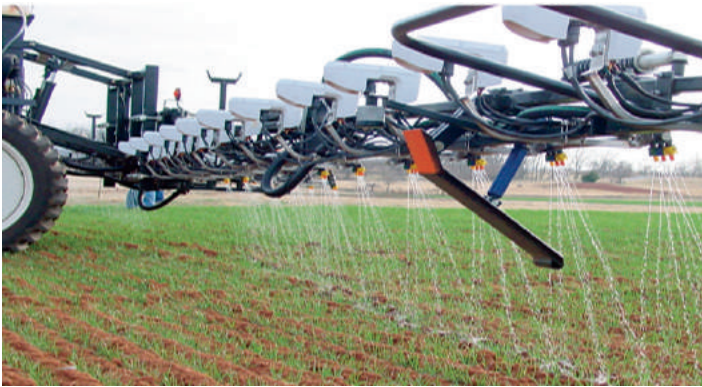
Рис. 5. Дифференцированное внесение жидких азотных удобрений по показаниям фотометров «Greenseeker», установленных на раме подкормщика
