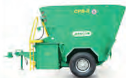
Смеситель-раздатчик кормов CPB-8
