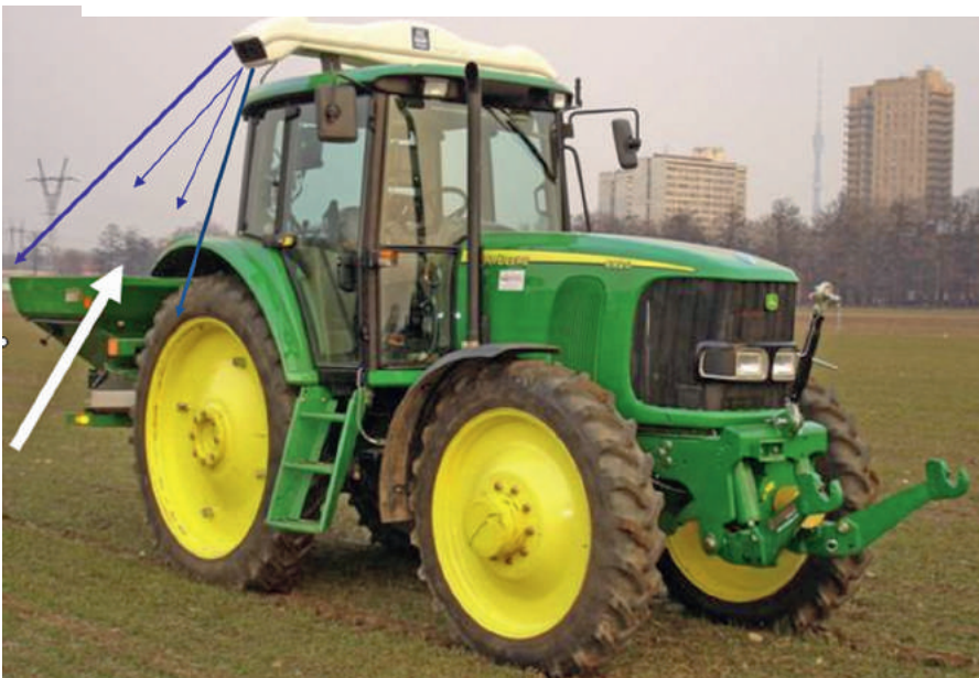
Рис. 5. Работа системы N-Sensor® ALS с машиной для внесения удобрений
