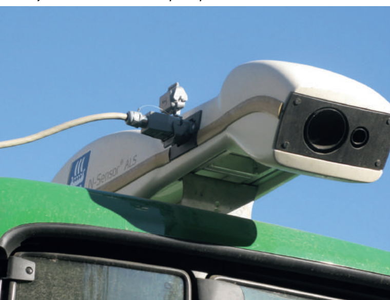
Рис. 3. Сканирующая система N-Sensor® ALS, установленная на кабине трактора
