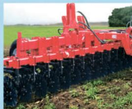
**КРОНА** - приставки прямого сева к серийным зерновым сеялкам типа СЗ (3,6, 5,4)
