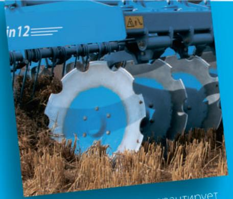
Диаметр диска 736 мм гарантирует даже при рабочей глубине 20 см интенсивное перемешивание почвы и пожнивных остатков
