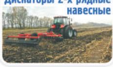
Для поверхностной обработки почвы на глубину 12-17 см, уничтожения сорняков, измельчения пожнивных остатков.
