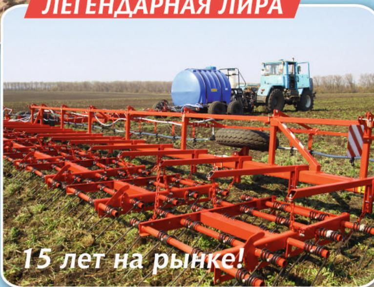
Бороны зубопружинные широкозахватные гидрофицированные 15 и 24 м.
