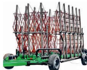
Разработаны и выпускаются гидрофицированные сцепки для навешивания этих борон в один ряд СПГ 9, 11, 15, 17, 21, 25, 27 и для навешивания в два ряда с шахматным расположением – СПГ-9-2, 11-2 (для тракторов МТЗ 80/82), СПГ 16-2, 18-2, 20-2, 22 2, 26-2, 28-2.
