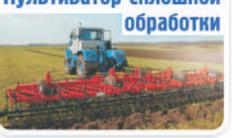
Для уничтожения сорняков, поверхностного (до 12 см) рыхления и мульчирования почвы с выравниванием микрорельефа и регулируемого уплотнения верхнего слоя почвы.
