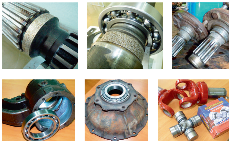
Рис.3. – Примеры восстановленных посадочных поверхностей тракторных полуосей, цапф, промежуточных опор, корпусов мостов, вилок карданных передач.
