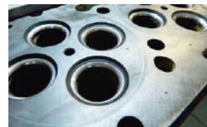
Рис.9.- Замена седел клапанов ГБЦ – привычное дело в моторном цехе, а ведь это тоже метод ДРД
