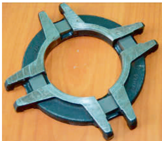
Рис. 8. Упрочнение пазов упорного кольца выжимного подшипника муфты сцепления твердосплавными (металлокерамическими) пластинками – об износе можно забыть!
