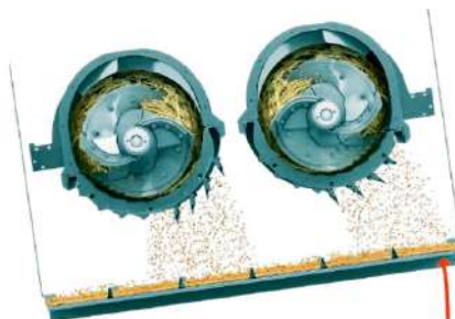
Рис. 3 – Схема работы системы очистки Claas 4D
