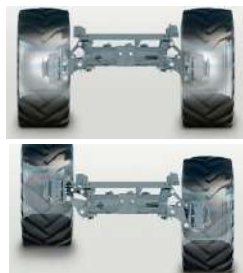
Рис. 12 – Механизм автоматического выравнивания колес на склоне
