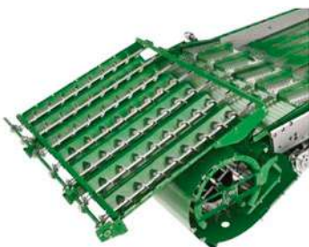
Рис. 8 – Устройство подачи вороха на очистку
