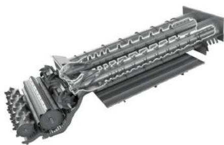
Рис. 2 – Молотильно-сепарирующее устройство комбайнов Lexion
